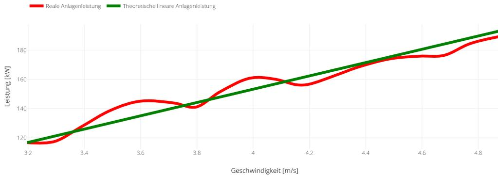
Die grüne Linie entspricht der theoretischen Anlagenleistung. Eine ideale Bahn (ohne Resonanzschwingungen, idealer Motorenwirkungsgrad) würde diesen Verlauf aufweisen. Die rote Linie entspricht der Anlagenleistung, welche gemessen wurde. Bei höherer Auslastung steigt die Anlagenkennlinie proportional an.
