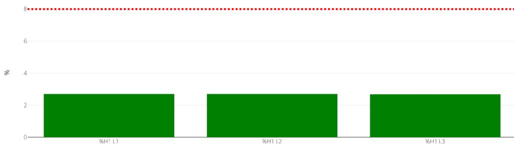
! Die Harmonische Oberschwingungen sollten den Wert von 8% auf der Netzseite nicht überschreiten. Zwischen FU und Motor gibt es keine gültige Netzqualitätsnorm. Hohe THD Werte könnten alte/defekte Filter, FU Parametrierung, ungenügende Kabelschirmung usw. sein. Bei Gleichstrommaschinen ist dieser Wert sehr hoch.
